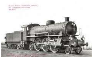
22820. ** Locomotiva a 4 cilindri eguali a vapore 3000
