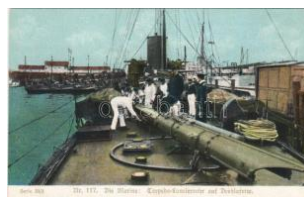
23491. ** Die Marine: Torpedo-Lancierrohr au T3 2600
